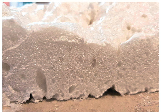
RALMO®-DÄMM feinzell Querschnitt nach 4 Stunden bei -15 °C Lagerung. Struktur sehr fein und nicht spröde.
