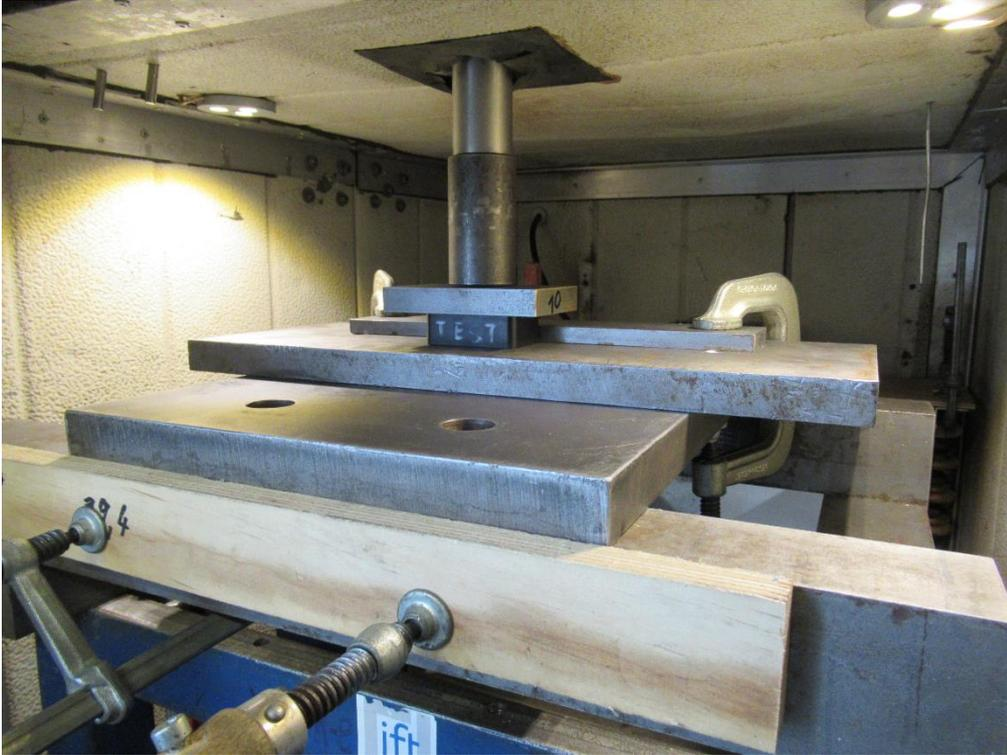
**Bild 6** Druckversuch Kunststoff Unterlegplatten 20 mm in der Klimakammer bei 0 °C
