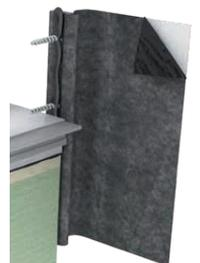
**Wichtig! Der Flansch muss vorne am Bodeneinstandsprofil bündig abschließen!**
