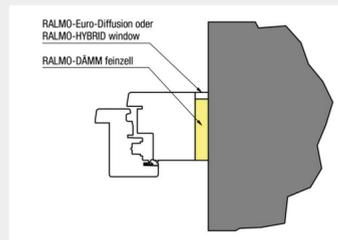
Das System entspricht nicht „innen dichter als außen“. Um einen Anschluss innen dichter als außen zu erhalten (3-stufiger Aufbau), kann innen ein RALMO®-Innendichtband oder z. B. durch den Stuckateur die Anputz-Dichtleiste Membran montiert werden. Auch andere geprüfte Anputz-Dichtleisten sind möglich.
